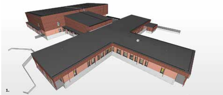
Kuva 1: Matalan ja korkean osan yhdistää koteloitu räystäärakenne, jonka metallikasetit kiertävät kokonaisuuden ympäri.
